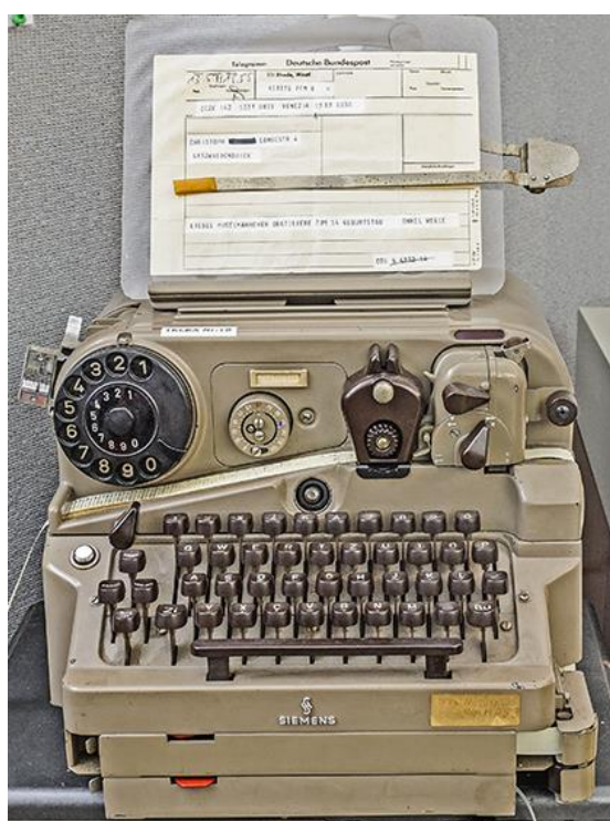
Siemens-Streifenschreiber T68D von 1950 - 1960 5 Bit Baudot Geschwindigkeit 50 Baud Streifenschreiber zur Übertragung von Telegrammen genutzt.
